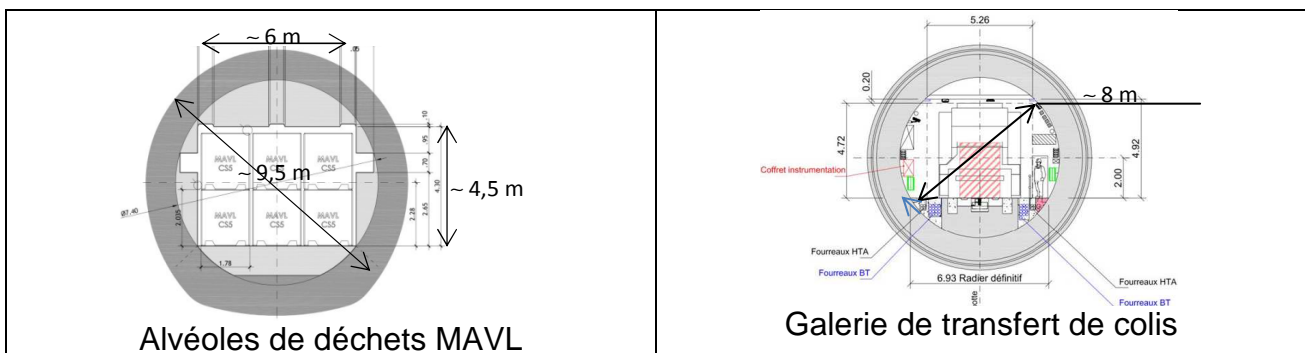
Figure 6 : Exemples de sections types d'ouvrages souterrains de Cigéo
