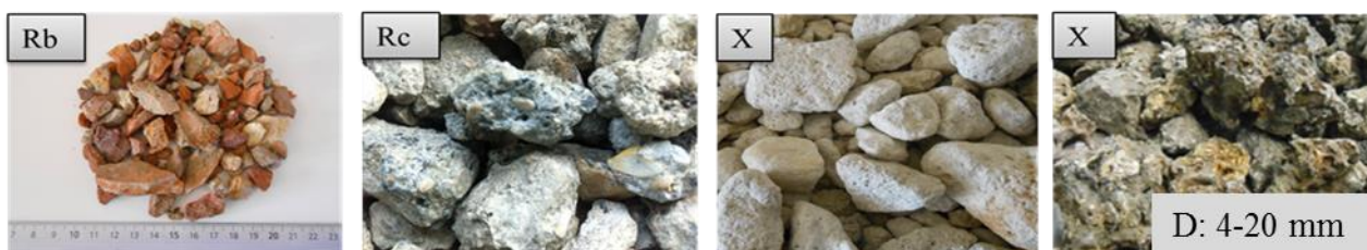
Figure 3: Composants du squelette granulaire des sols urbains étudiés
