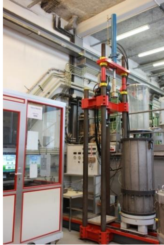
Figure 1. Vue d'ensemble du dispositif d'essai en chambre d'étalonnage
