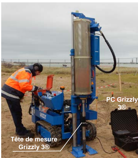
Figure 2 : Tête de mesure Grizzly 3® sur le terrain et exemple de courbe charge-enfoncement ( \sigma_p-s_p ) réalisées à l'aide de la tête de mesure Grizzly 3®.
