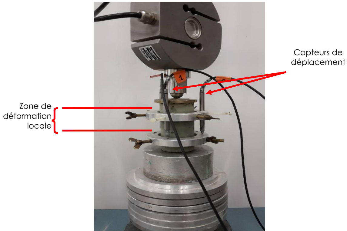
Figure 2. Essai de compression et zone de calcul du E_{50\text{local}}
