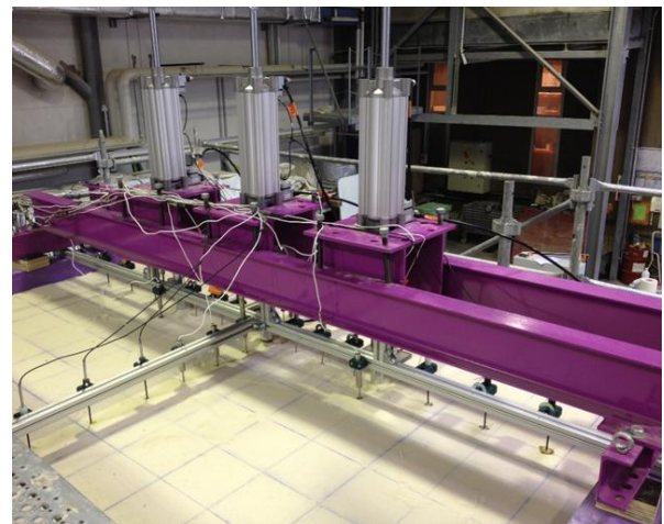
Figure 3. Dispositif de chargement des pieux et instrumentation de surface.
