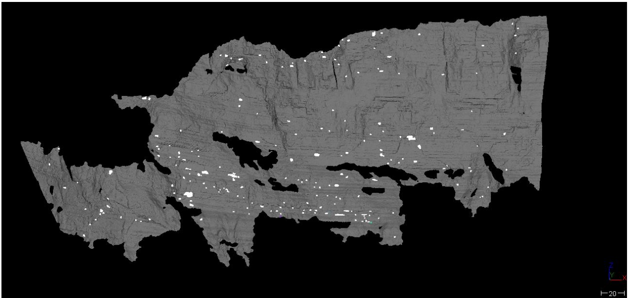
Figure 2. Chutes détectées dans la falaise inférieure du Mont Saint-Eynard, par comparaison des modèles numériques de falaise obtenus par scanner laser terrestre en 2009 et 2012 (233 chutes de plus de 0,1 \text{ m}^3 ).
