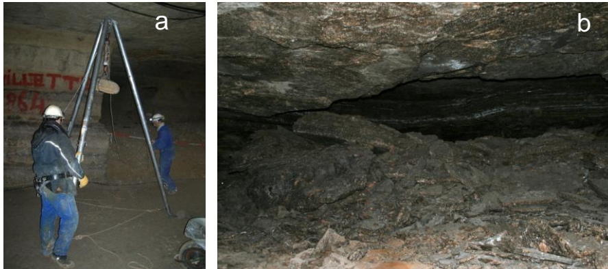
Figure 4. a : Simulation de chutes de bloc de calcaire dans une carrière abandonnée en région parisienne. b : Chute de toit évaluée à 200 tonnes enregistrée par le réseau de surveillance acoustique en place.
