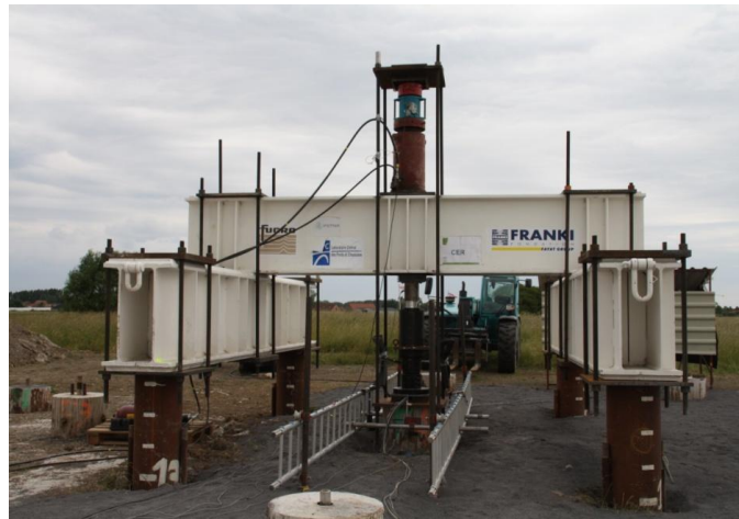
Figure 7. Photo du montage d'un essai de chargement cyclique alterné.
