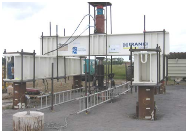
Figure 2. Dispositif de chargement des pieux pour essais cycliques alternés
